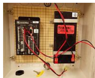
内部は、G-CR200X と 鉛電池のみと シンプルな構造
