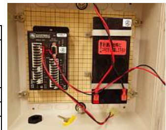
内部は、C-CR200Xと鉛電池のみとシンプルな構造
