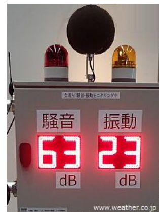
ウェザーチェック 騒音振動モニターシステム
