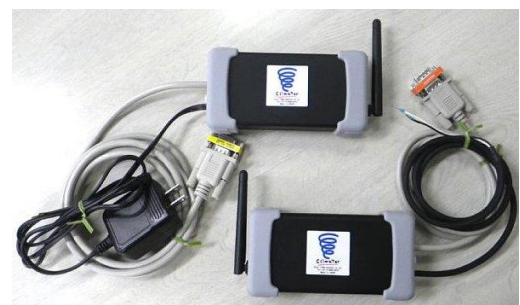
上側が PC 側(AC アダプター付属) 下側が子局のロガー接続用(DC12V 供給)
